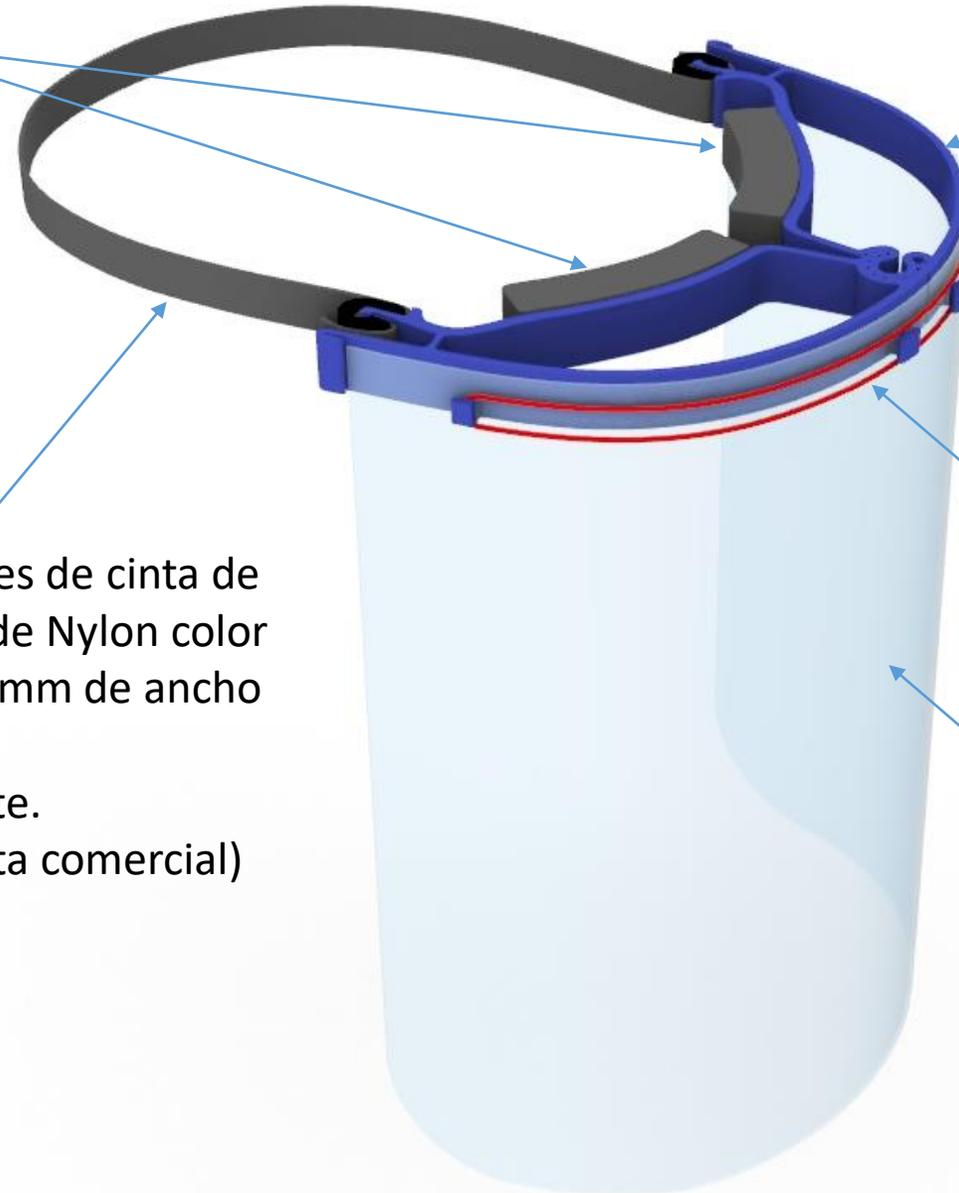
Armazón en 2 piezas manufacturado por inyección de Polipropileno (PP) con carga de talco para endurecer, color azul (falta especificación de color)
