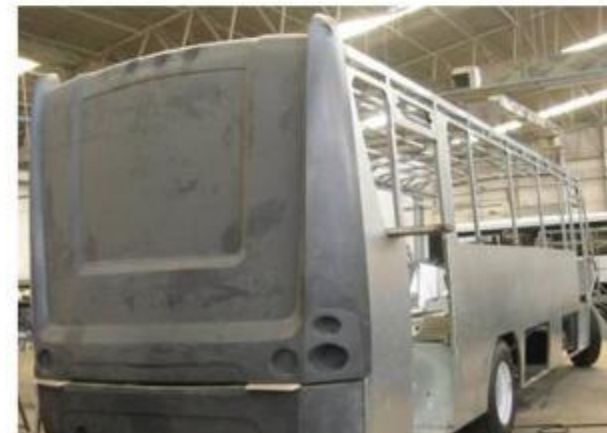
CONSTRUCCIÓN MODELOS PARA MOLDES Y PARTES PROTOTIPO DE CONCHA TRASERA, OB1-EVO
