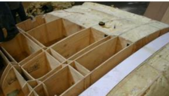
CONSTRUCCIÓN MODELOS PARA MOLDES Y PARTES PROTOTIPO DE CONCHA TRASERA, OB1-EVO
