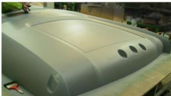
CONSTRUCCIÓN MODELOS PARA MOLDES Y PARTES PROTOTIPO DE CONCHA TRASERA, OB1-EVO
